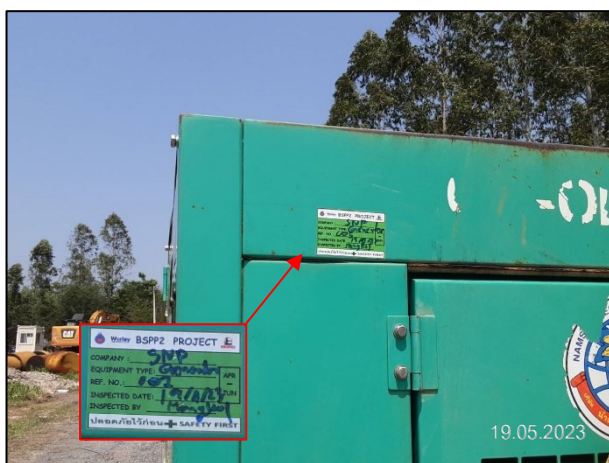
รูปที่ 2-9 การติดแถบสีสติ๊กเกอร์แสดงการตรวจสอบสภาพของเครื่องจักรและอุปกรณ์ต่างๆ
