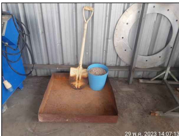
รูปที่ 2-19 จัดเตรียมภาชนะรองรับป้องกันการหกรั่วไหลของน้ำมันและสารเคมี พร้อมทั้งวัสดุดูดซับ
