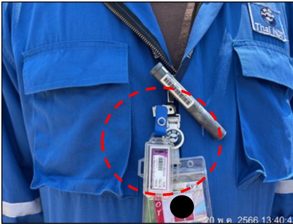
แผ่นวัดรังสีชนิด Optically Stimulated Luminescence (OSL)
