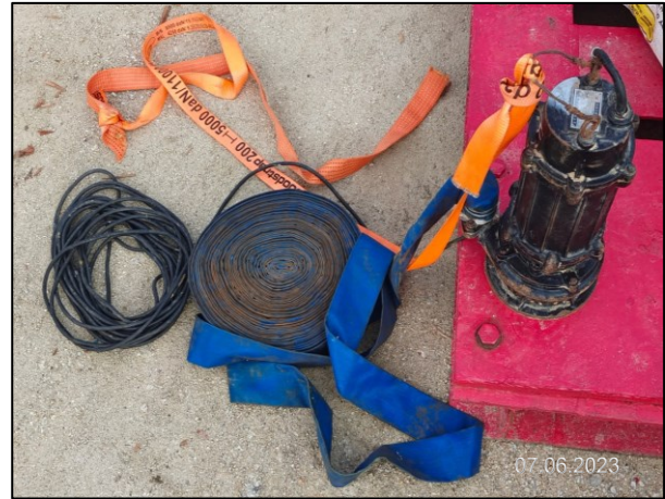
รูปที่ 2-22 เครื่องสูบน้ำแรงดันต่ำสำรองประจำพื้นที่ก่อสร้าง
