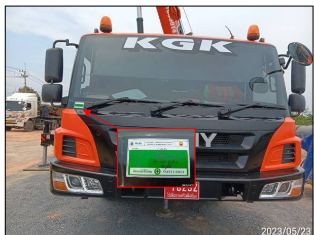
รูปที่ 2-9 การติดแถบสีสติ๊กเกอร์แสดงการตรวจสอบสภาพของเครื่องจักรและอุปกรณ์ต่างๆ
