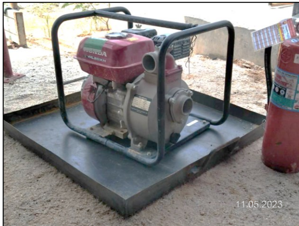
รูปที่ 2-22 เครื่องสูบน้ำแรงดันต่ำสำรองประจำพื้นที่ก่อสร้าง
